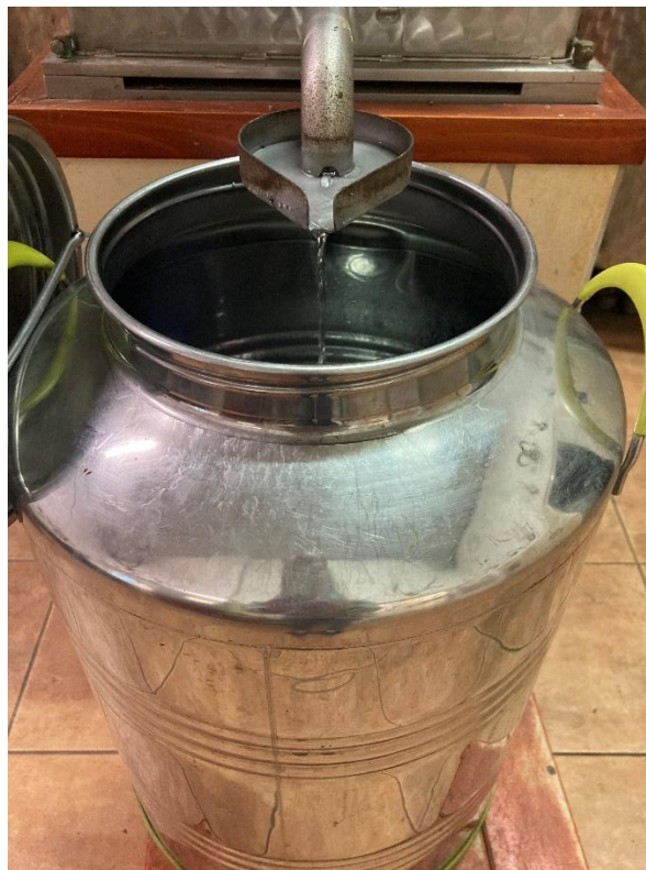
20. ábra: Tömény pálinka tárolására alkalmas saválló tárolóedény
