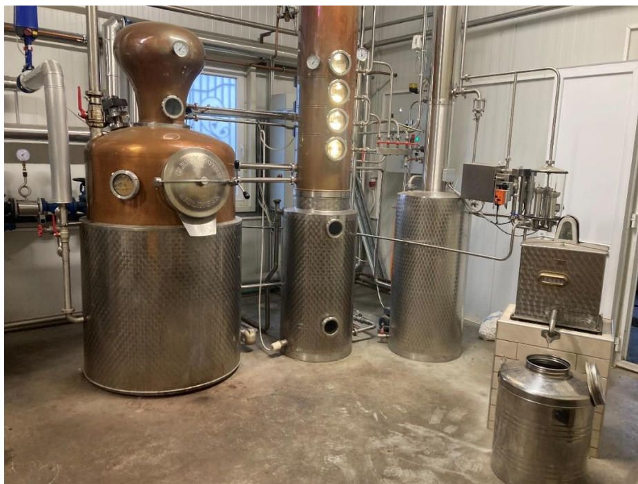
19. ábra: KOTHE K 1000N nagyteljesítményű pálinkafőző berendezés
