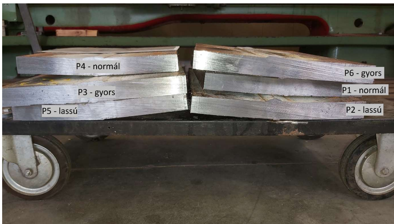
9. ábra – A kész munkapróbák szögzsugorodása [Saját ábra]
