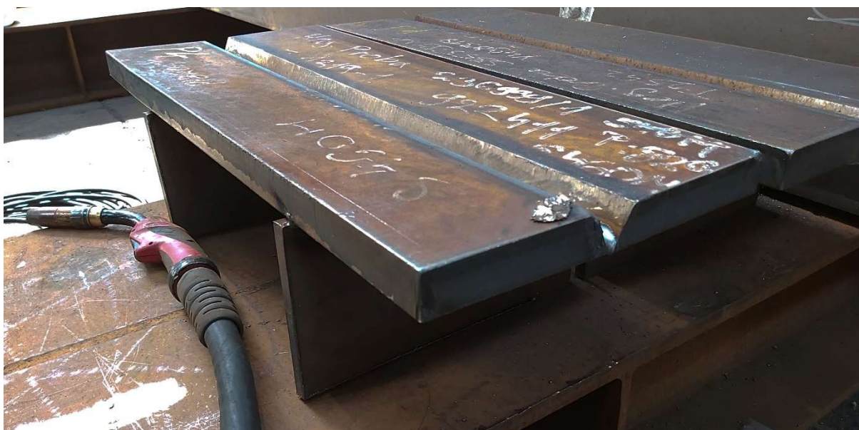
6. ábra - Alakváltozás csökkentése merevítő bordákkal [Saját ábra]
