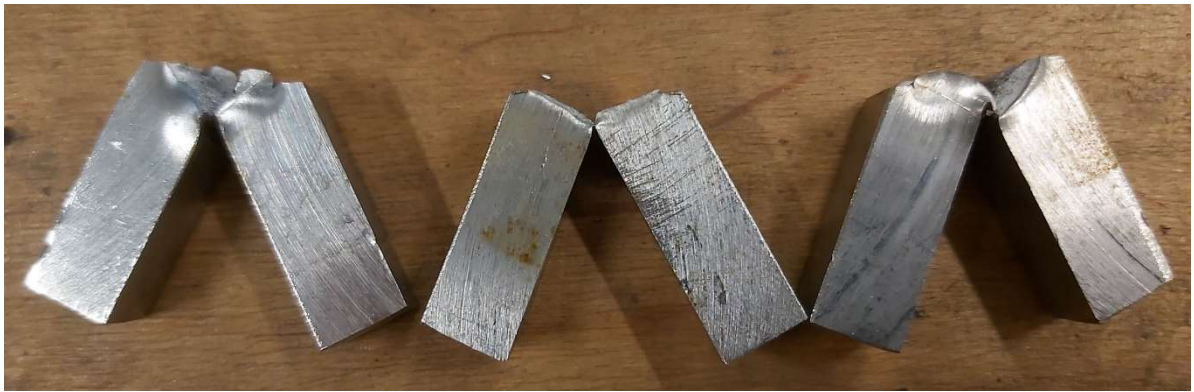
13. ábra – Eltört ütő próbatestek (Balról: P1, P2, P3) [Saját ábra]
