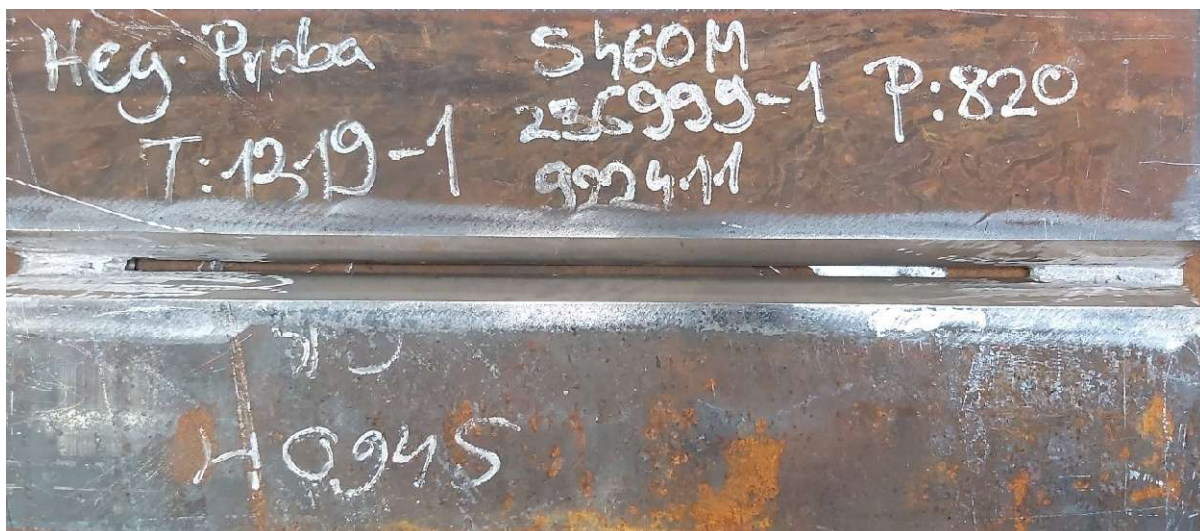
5. ábra – Fűzővarratok és az illesztési hézag [Saját ábra]
