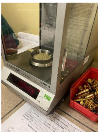
11. Kép: Lőpor tömeg mérés 38
