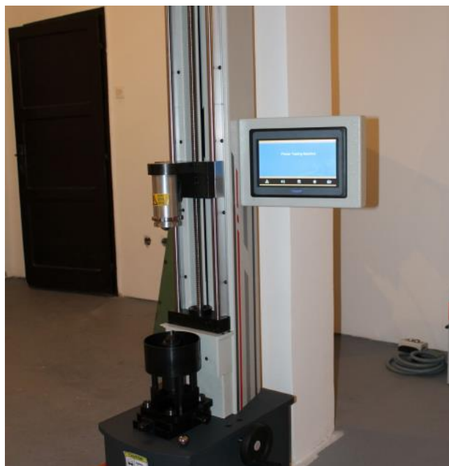
12. Kép: Csappantyú érzékenység tesztelő berendezés 39
