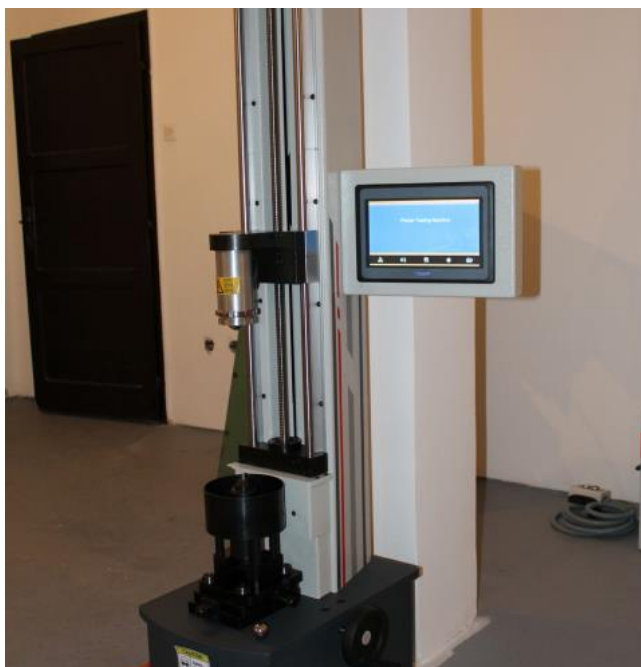
12. Kép: Csappantyú érzékenység tesztelő berendezés 39
