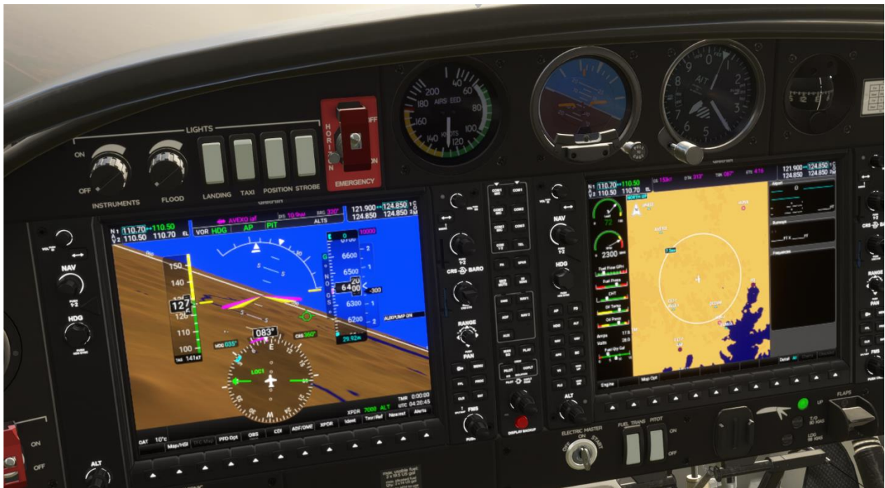
3. ábra: Garmin G1000 elektronikus repülőgép fedélzeti-műszer rendszer imitálása, forrás: saját képkivágás a Microsoft Flight Simulator programból, légijármű: Diamond DA40NG
