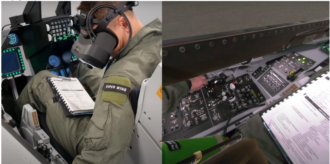
5. ábra: kevert valóságot alkalmazó szimulátor, amit az oktató, valamint oktatót lát; forrás: https://www.youtube.com/watch?v=wIB51dSkqw8
