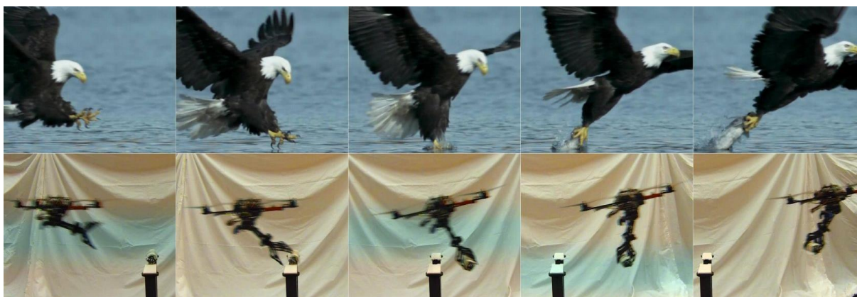
18. ábra Ragadozómadarak karmának mozgását imitáló drón tesztelése [26]
