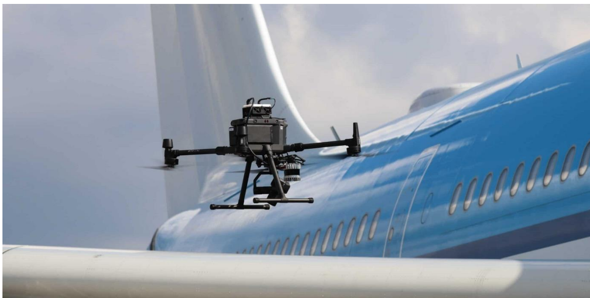
4. Ábra – Drón vizsgálja felszállás előtt a KLM Airbus A-350 típusú utasszállító repülőgépét.
