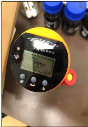
4.3. ábra Oxi-Top manometrikus mérőfej
