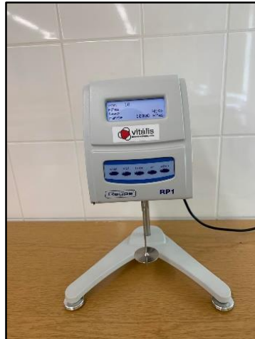
4.7. ábra Trade Raypa RP1 rotációs viszkoziméter
