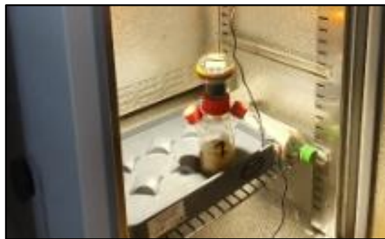
4.5. ábra Az anaerob fermentáció színteréül szolgáló fermentor inkubációja
