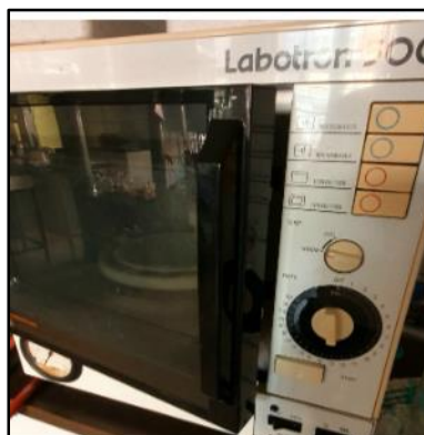
4.2. ábra Labotron 500 laboratóriumi minőségű szakaszos mikrohullámú készülék
