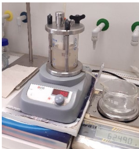
14. ábra: Membránszűrés a Millipore XFUF07601 reaktorról
