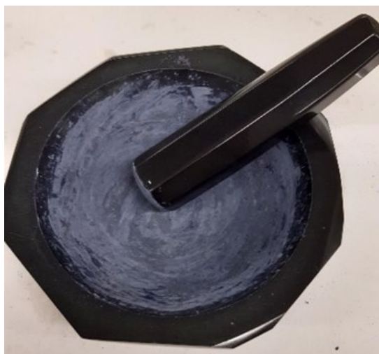
3. ábra: A \text{TiO}_2/\text{CNT} kompozit előállítása dörzsmozsárban
