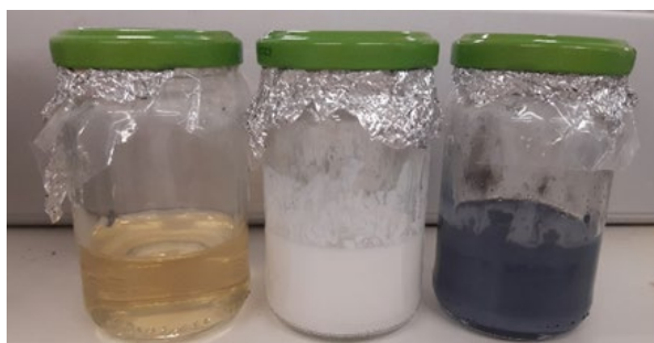
6. ábra: Membrán prekursor oldat nanorészecske nélkül (bal oldalon), és a prekursor szuszpenziók \text{TiO}_2 -dal és \text{TiO}_2/\text{CNT} -vel (középen és jobb oldalon)
