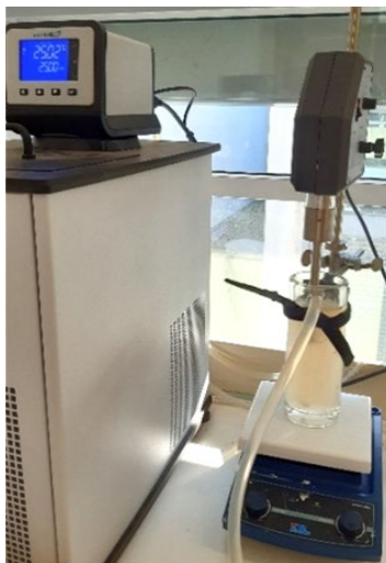
12. ábra: Hielscher UP200S ultrahangos homogenizáló készülék és a kezelt emulzió
