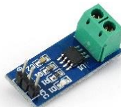
32.ábra: ACS712-5A-M típusú áramérzékelő modul ( nettigo.eu , 2022. 08. 22)
