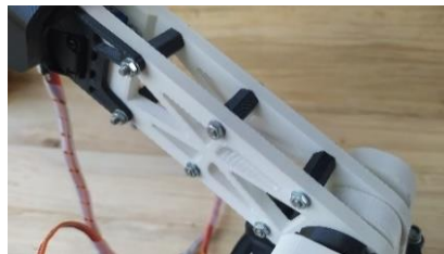
40.ábra: A szegmensek merevségét adó rögzítő csavarok és távtartók
