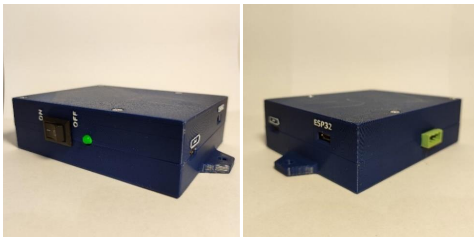
20. ábra Az áramkör védőburkolata (saját fotó)
