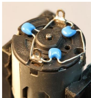
12. ábra: Zajsűrő kondenzátorok BDC motorra kapcsolva ( www.learn.adafruit.com , 2022)
