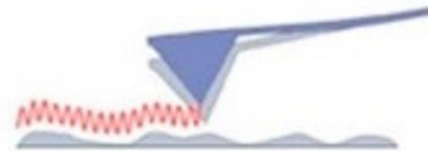
6. ábra AFM üzemmódok sematikus ábrája
