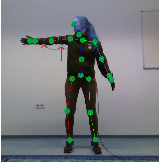
5.6. ábra. A párhuzamos mérés szkeletonizálásából kivágott képkocka. A mérési alany a kiindulási pozíciót vette fel. Az alany karján piros nyilakkal jelölve látszódik a felszerelt három darab IMU-ból az első kettő (alkarra és felkarra jutó) szenzor is.
