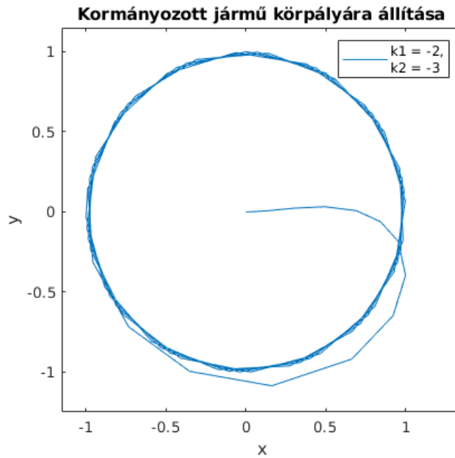
4.2. ábra. Egy kormányozott jármű négyzetes integrátorral való szabályozásának pályája. A körpályára állítás a k_1 = -2 , k_2 = -3 paraméterekkel valósult meg.
