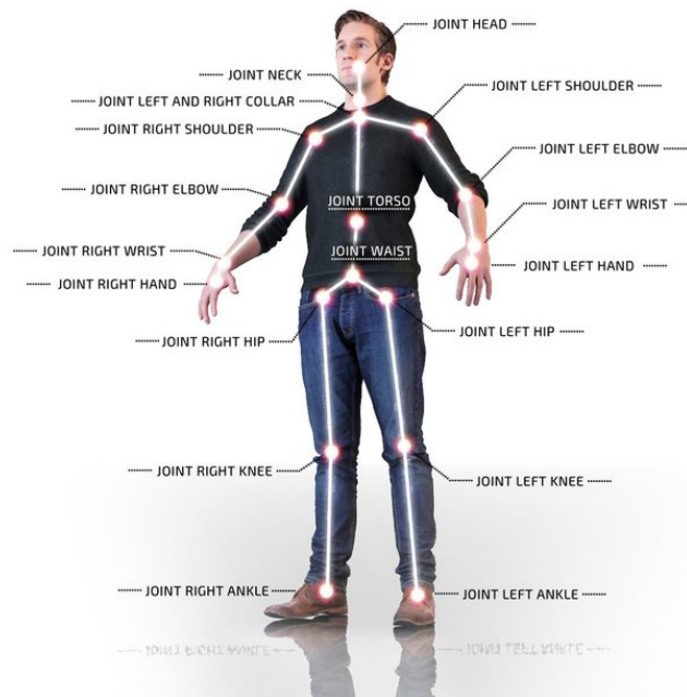
6.1. ábra. A NuiTrack által illesztett 19 marker elhelyezkedése az emberi testen. (Az ábra forrása: [40].)
