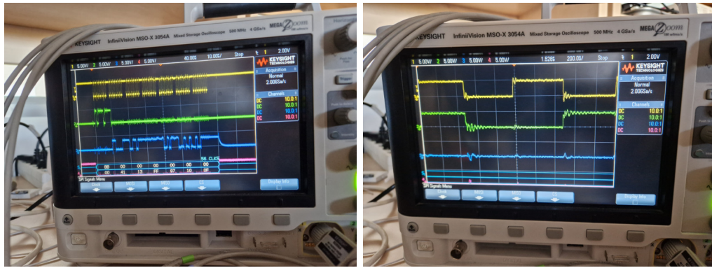
5.5. ábra. Az IMU-kat hosszú vezetékkel és három ellenállással kiegészítve az oszcilloszkóp által ábrázolt idődiagram különböző nagyítások mellett.
