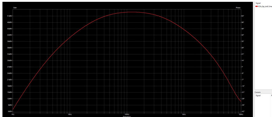
4.6. ábra. A sáváteresztő szűrő frekvencia áteresztési karakterisztikája.
