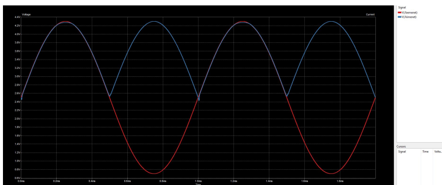
4.8. ábra. A második egyenirányító blokk szimulációjából kapott jelforma diagram. A piros görbe a feszültségforrás feszültsége, a kék görbe pedig az egyenirányított jel.
