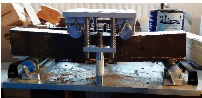
45. ábra: Hajlított mintatest a vizsgálat után [1]
