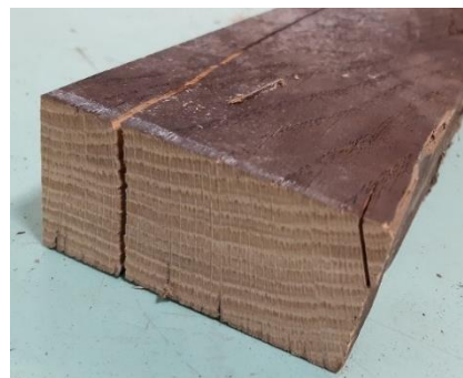
49. ábra: Nyírási repedés [1]
