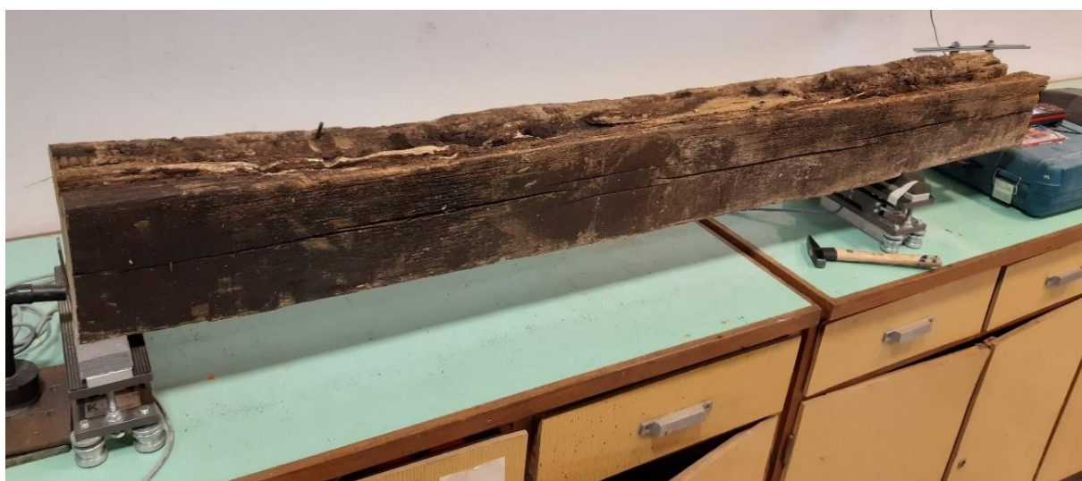
30. ábra: A szerkezet felépítése: Baloldalon a mikrofon, jobb oldalon a lézer, alátámasztásnál szivacsos mérleg, a minta mellett kalapács [1]
