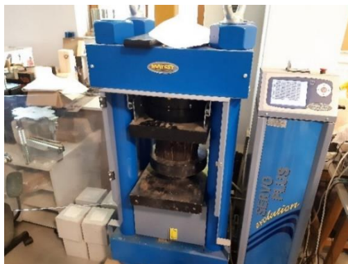
36. ábra: Nyomószilárdsági vizsgálat [1]
