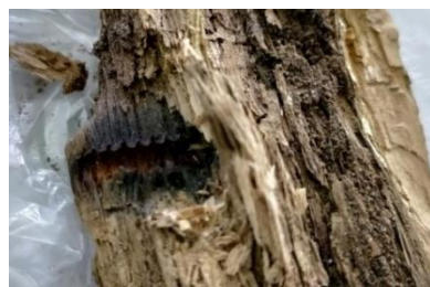
21. ábra: Csavarhely oxidációja [1]
