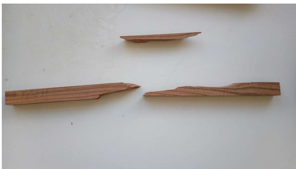
30. ábra: Az amerikai kőris 180 °C-on kezelt faanyagának törési képe
