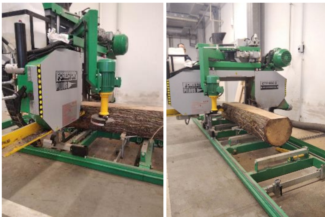
8. ábra Vizsgált tölgy mintatestek készítésének folyamata (rönkfelvágás)
