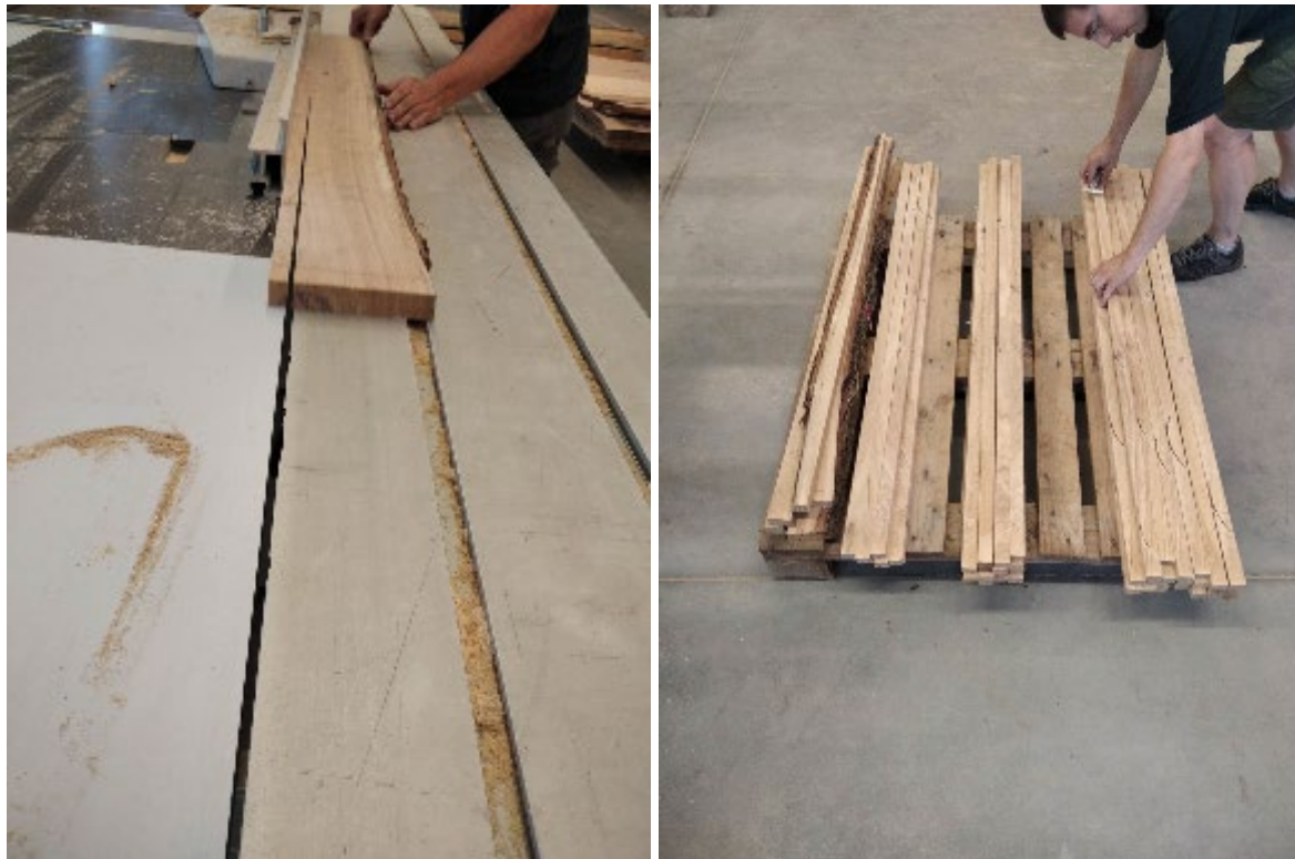
11. ábra Vizsgált tölgy mintatestek készítésének folyamata (Minták pontos méreteinek kialakítása és osztályozása)
