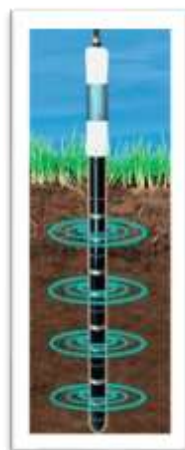
6. ábra: Több mélységben talaj-nedvességet mérő szonda, Forrás: https://magyarmezo-gazdasag.hu/2017/12/27/xxi-szazad-mezogazdasaga
