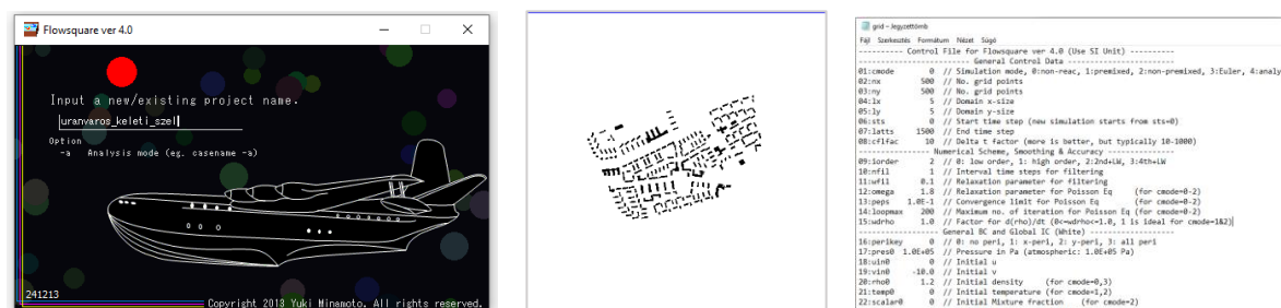
19. ábra: A Flowsquare4.0 a projekt nevének megadása után a megadott modellterben (bc.bmp, középen) a megadott légköri és számítási paraméterek szerint (grid.txt, jobbra) lefuttatja a 2D szimulációt (forrás: saját szerkesztés)
