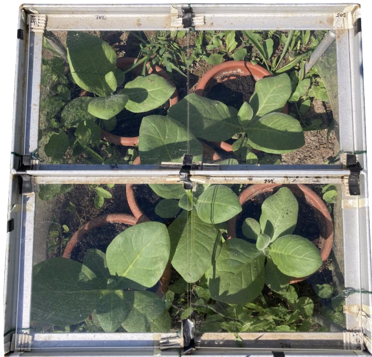
1. ábra: A kísérlet során használt elrendezés. A dohánynövények szabadföldön egy 4 darab, azonos típusú üvegszűrőből álló platform (35 x 35 cm) alatt nevelkedtek a vetéstől a mintavétel napjáig ( n = 5 ). A túlzott kiszáradást megelőzendő, a cserepeket beástuk a földbe és naponta öntöttük.
