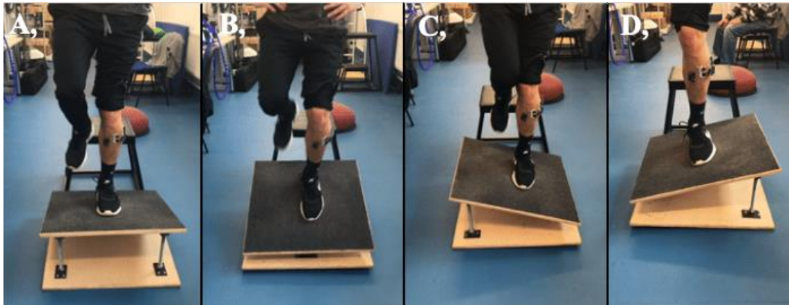
3.ábra: A bokaízület négy különböző irányba billentése az általunk tervezett billenőfelület segítségével: (A) dorsalflexió, (B) plantarflexió, (C) supinatio, (D) pronatio.
