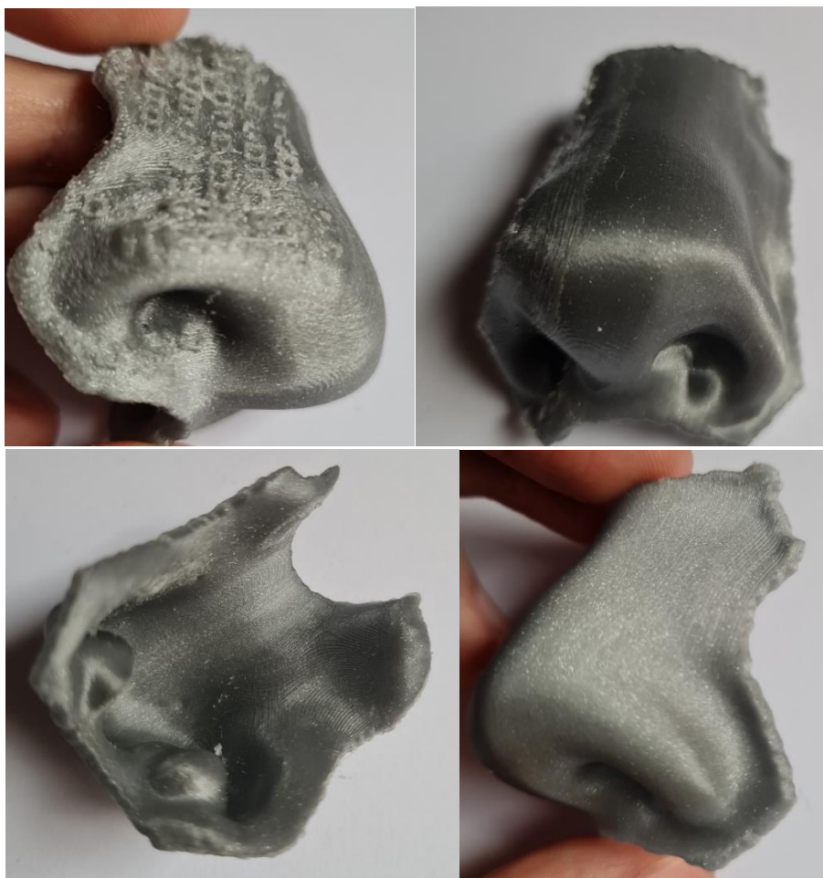
22. ábra Orr külső része kemény anyagból nyomtatva
