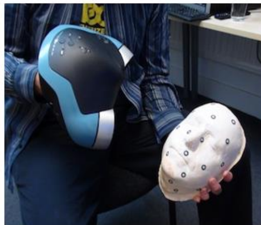
6. ábra HandySCAN 3D és egy folyamat működés közben
