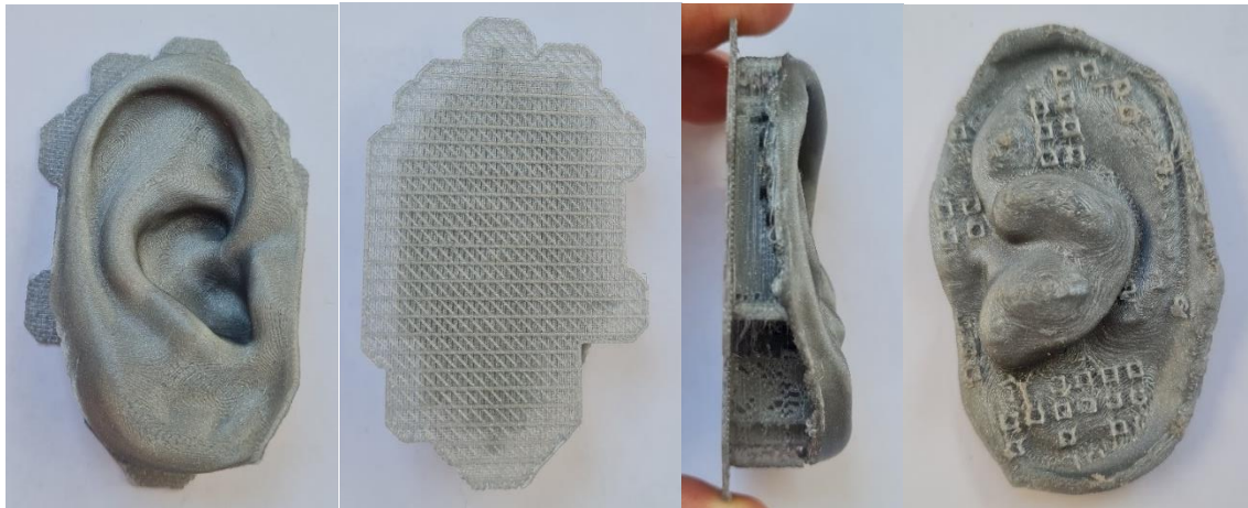
15. ábra Az első sorjázott kemény anyagú prototípus
