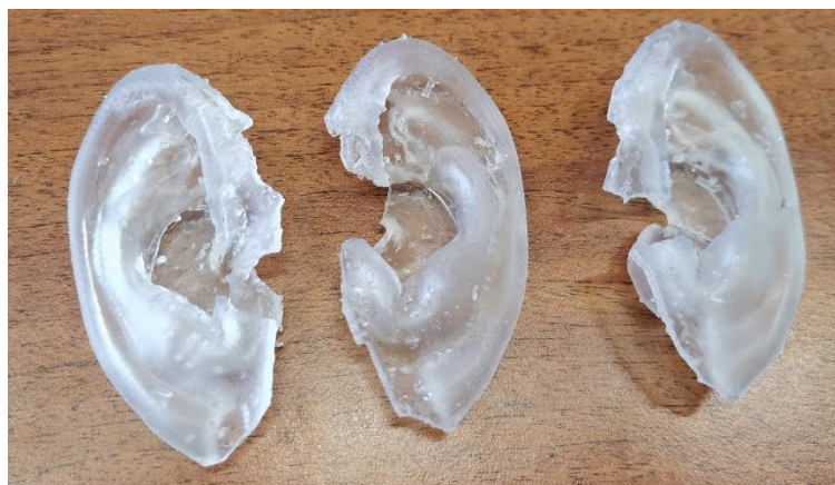
23. ábra Műgyantás nyomtatványok, amelyek selejtesek lettek. A sorjás rész nehezen távolítható el, valamint a vékony rétegek sérülékenyek.
