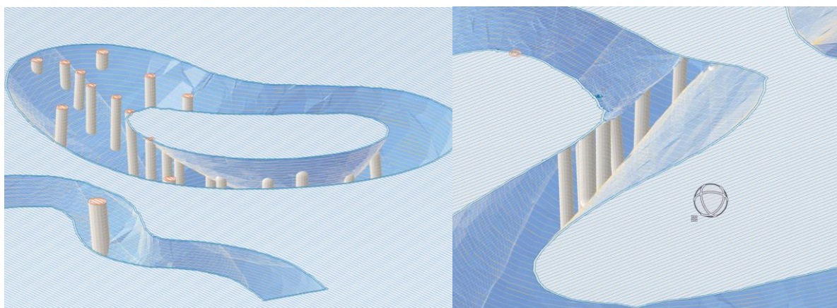
20. ábra Alátámasztások, melyek vízben oldható módon távolíthatók el
