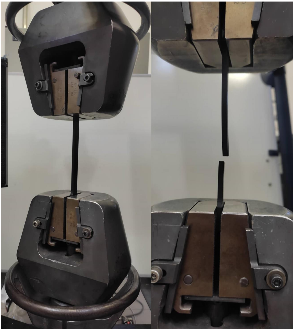
19. ábra: Szakító vizsgálat [saját forrás]
