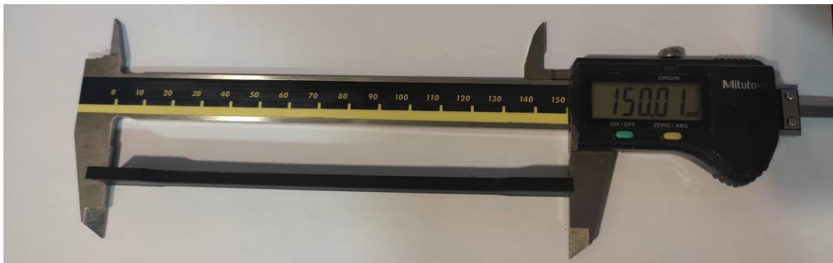
15. ábra: Példa vetemedésre [saját forrás]
