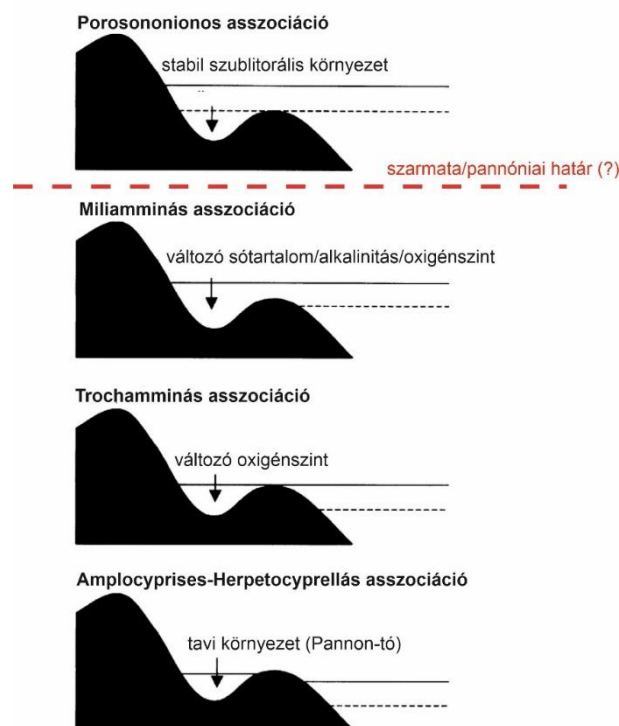
14. ábra Sematikus ábra a szarmata/pannóniai határon lezajlott környezetváltozásról a vizsgált képződményekből kimutatott foraminifera és ostracoda asszociációk feltüntetésével (Lloyd & Evans 2002 felhasználásával)
