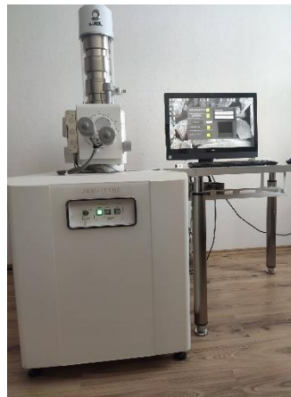
4. ábra Jeol JSM-IT100 típusú pásztázó elektronmikroszkóppal
