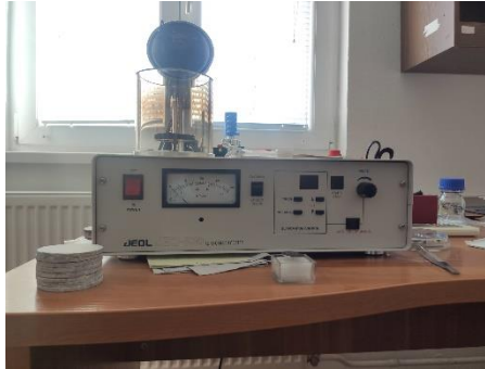
3. ábra Jeol JEC-530 Auto Carbon Coater gép
