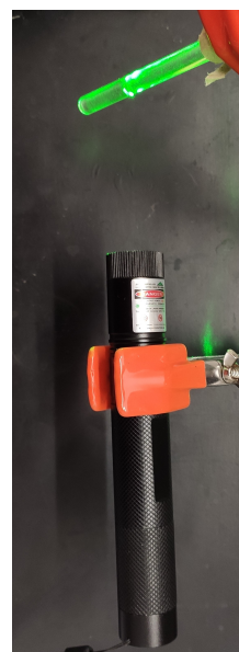
2.2. ábra. A méréshez használt zöld fényű csillagászati lézer, illetve a sík fénynyaláb létrehozásához használt üveghenger. (A kép 90°-al el van forgatva.)
