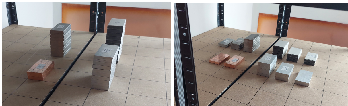
30. ábra. A mintasereget két külön futtatásban mértem, hasonló módon elhelyezve: Különböző magasságú ólom (jobb hátul), acél (bal hátul), alumínium (jobb elöl), és réz (bal elöl) mintákat vizsgáltam. Mindkét mérés 15 napig tartott.
