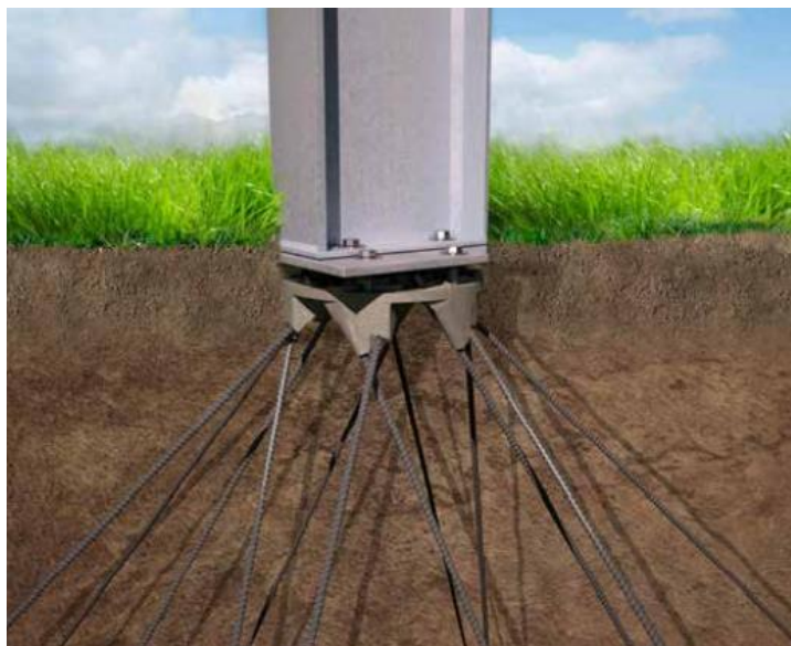
5. ábra: A fák gyökereihez hasonló állványzat-rögzítés. A kép forrása: Fraunhofer ISE Guideline (2020)
