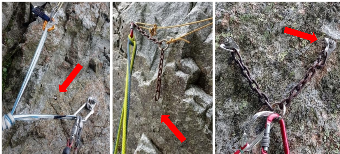
(1-2-3. kép: Sziklaomlás következtében ütődéstől letört/kiszakadt és elhajlott stand nittek, forrás: Seregi Ernő képei)
