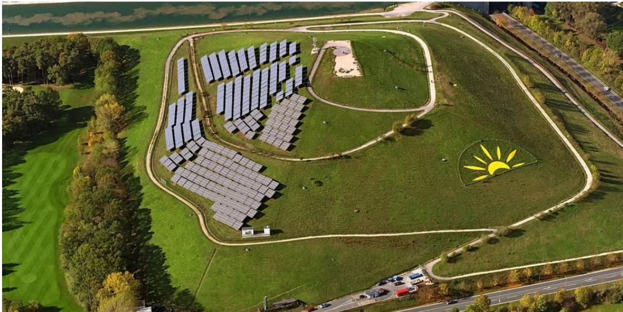
8. ábra. Atzenhofi hulladéklerakón telepített 1 MW-os napelempark (készítette: Hajo Dietz)
