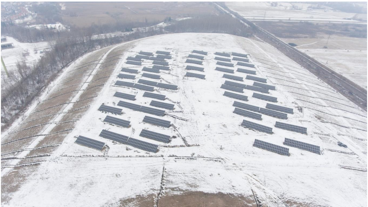
9. ábra. A Bogács utcai hulladéklerakóra telepített 1 MW-os napelempark Miskolcon (MISKOLCI ÖNKORMÁNYZAT, 2019)
