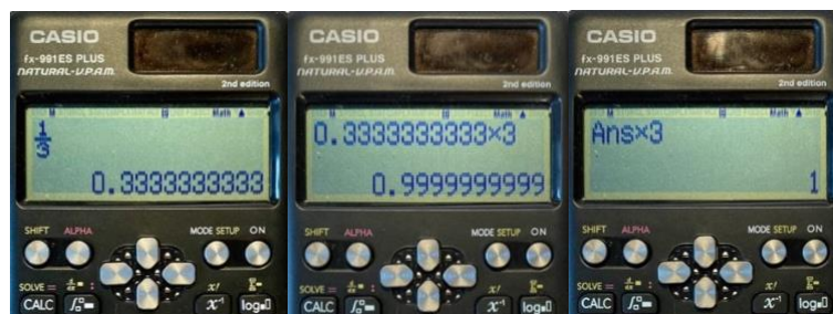
1. ábra: A számológéppel eltérő eredményeket kaphatunk az ANS funkcióval és a kimásolással.
