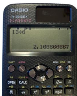
3. ábra: A 13/6 pontos értéke 2,1\bar{6} , de a számológép ezt a végtelen szakaszos tizedes törtet kerekíti.
