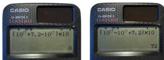
2. ábra: A nagy nagyságrendbeli különbségekkel nehezen dolgoznak a számológépek.
