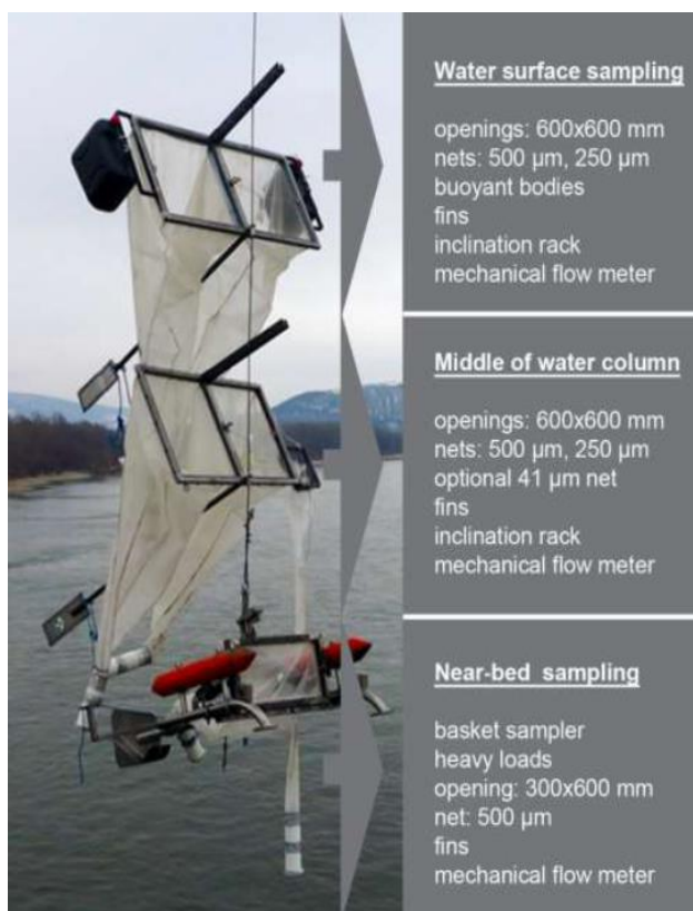
1. ábra Mikroműanyag folyami mintázásra kialakított, hálós mintavevő (Liedermann és társai, 2018).
