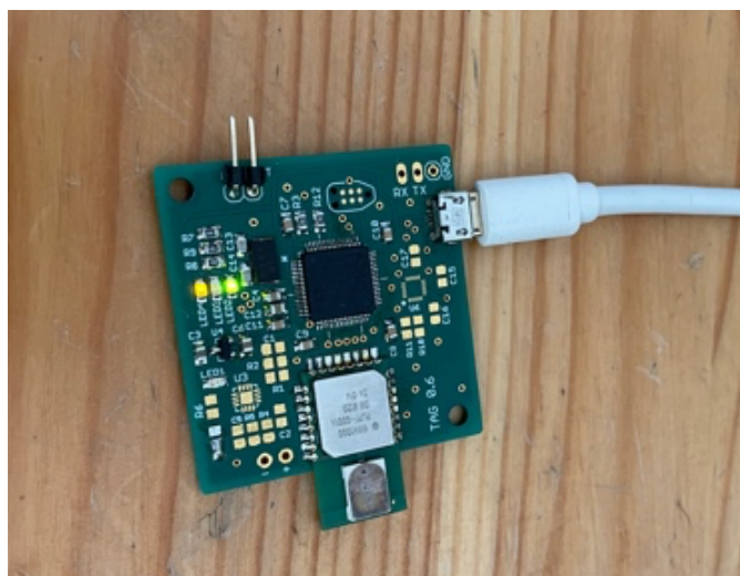
5. kép: A működés időbeli szinkronját biztosító gateway
