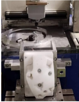
3. ábra: Tamponozó állomás
