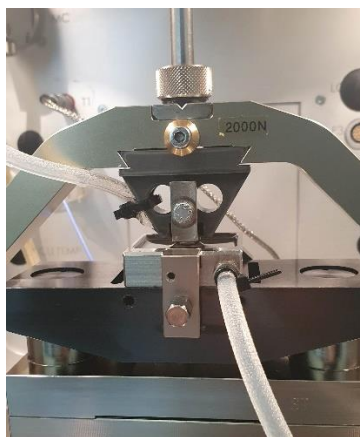
14. ábra: Beszerelt golyós rögzítő, olajkád és próbatestek.
