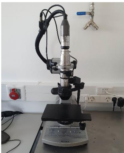
7. ábra: Keyence VHX-1000 típusú mikroszkóp.
