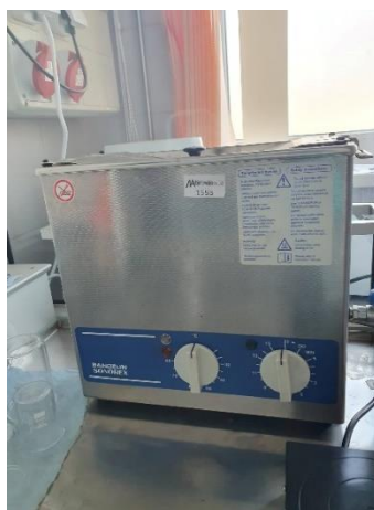
10. ábra: Mérések előkészítése során használt ultrahangos tisztító.
