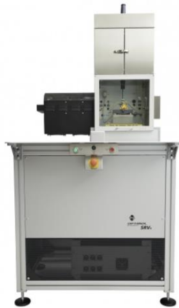
4. ábra: Optimol SRV®5 tribométer [17].
