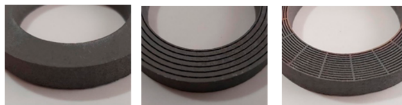
4.12. ábra. 3D nyomtatott FeSi toroidok légréssel ellátva a vasveszteségek csökkentése érdekében. (forrás: [18])
