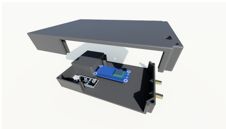
ábra 6. Tokozás elemeinek ábrázolása (fent) Render ábra 3D tervezett tokozásról légminőségmérő műszerhez (lent)
