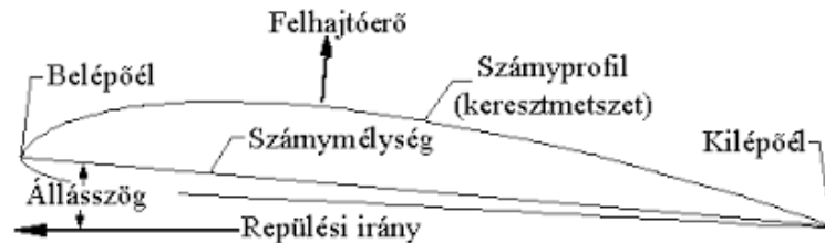
2-6. ábra: Szárnyprofil fontosabb elnevezései [5]
