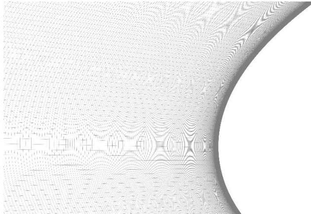
3-10. ábra: Szárnyprofil belépőélénél a hálófelosztás az I. geometrián
