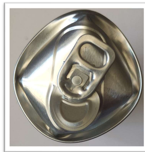
16. ábra Jellemző nyitás és alakváltozás IV.
