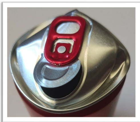
13. ábra Jellemző nyitás és alakváltozás I.
