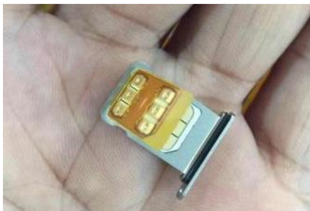
12. kép: SIM kártya TurboSIM mikrokontrollerrel. 106
