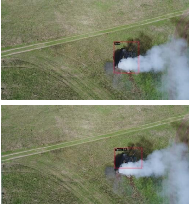
19. ábra: Példa egy félig kitakart minta detektálására. Fent az elvárt kimenet, lent pedig a detektor kimenete látható.
