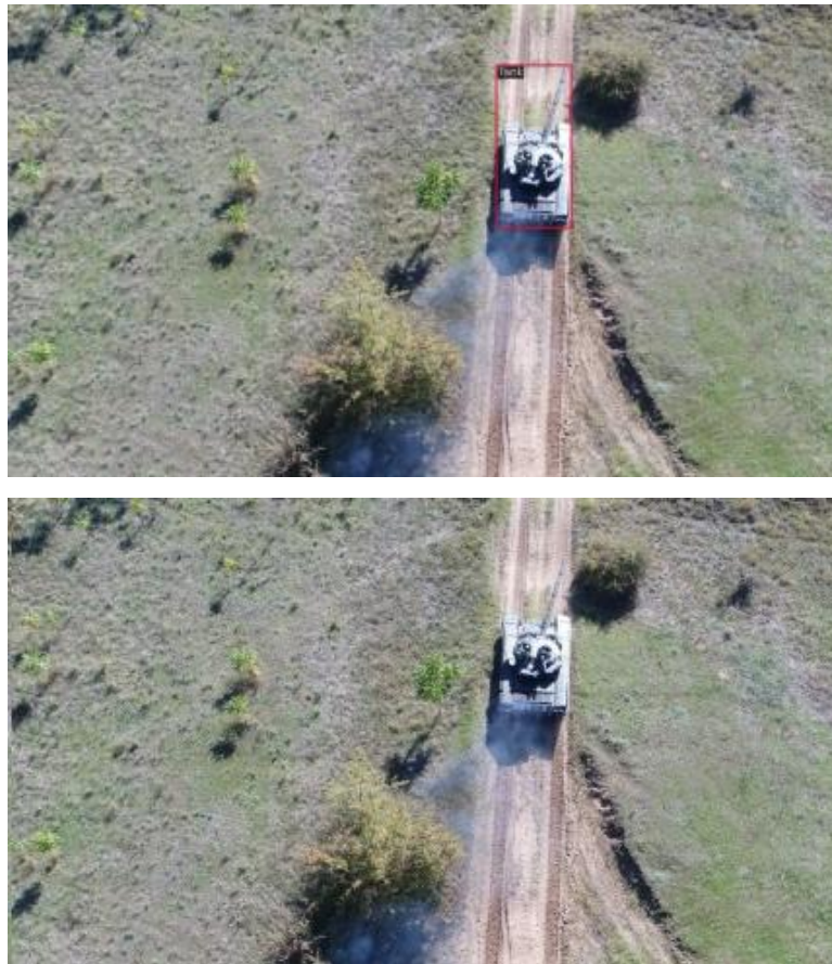
22. ábra: Harckocsi felülnézetből napsütésben. Fent az elvárt kimenet, lent pedig a detektor kimenete látható.
