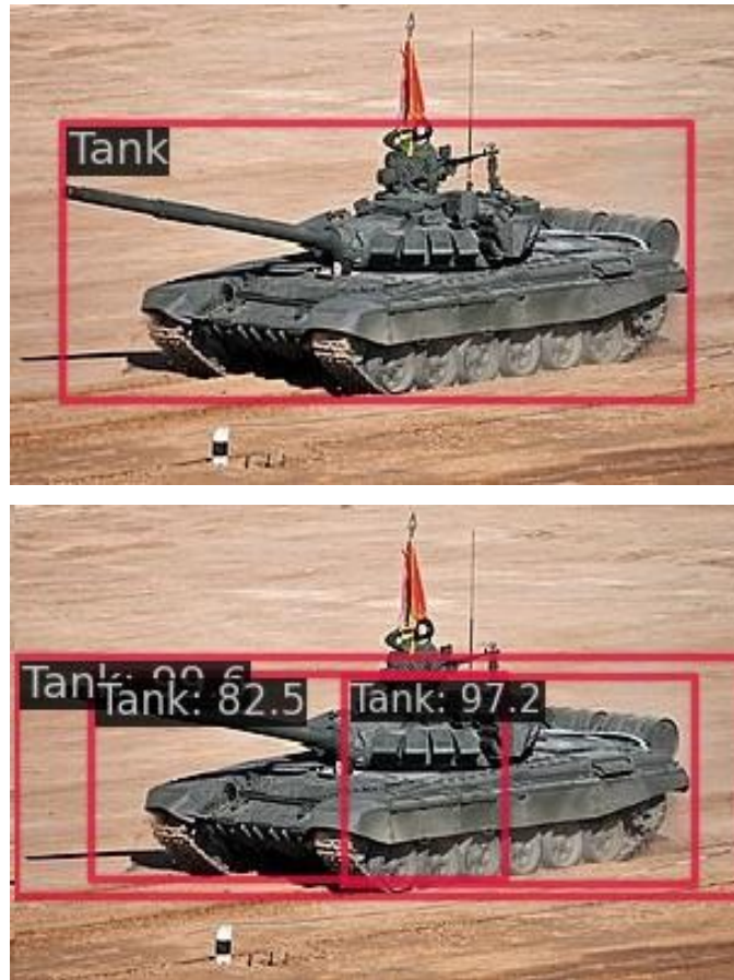
21. ábra: Példa többszörös detektálásra Faster R-CNN esetén. Fent az elvárt kimenet, lent pedig a detektor kimenete látható.
