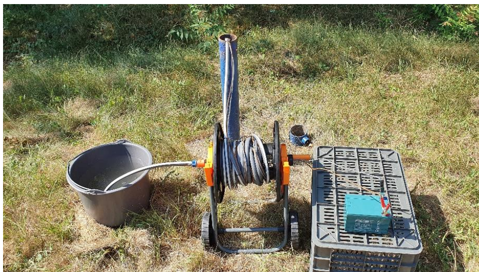
28. ábra: Vízmintavétel folyamata talajkútból (Saját felvétel, 2022. 07. 05.)
