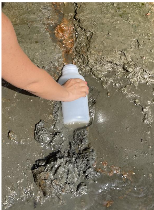
17. ábra: Vízmintavételezés egy felszíni alatti hozzáfolyásból (Saját felvétel, 2022. 07. 05.)
