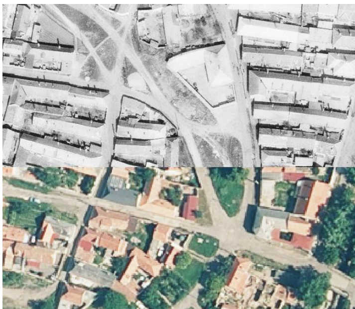
11. ábra: Az áttanszformált archív felvétel és a napjainkban készült ortofotó illeszkedése nem hibátlan, ám az eltérés a kép bármely pontján 7 m alatt marad.
