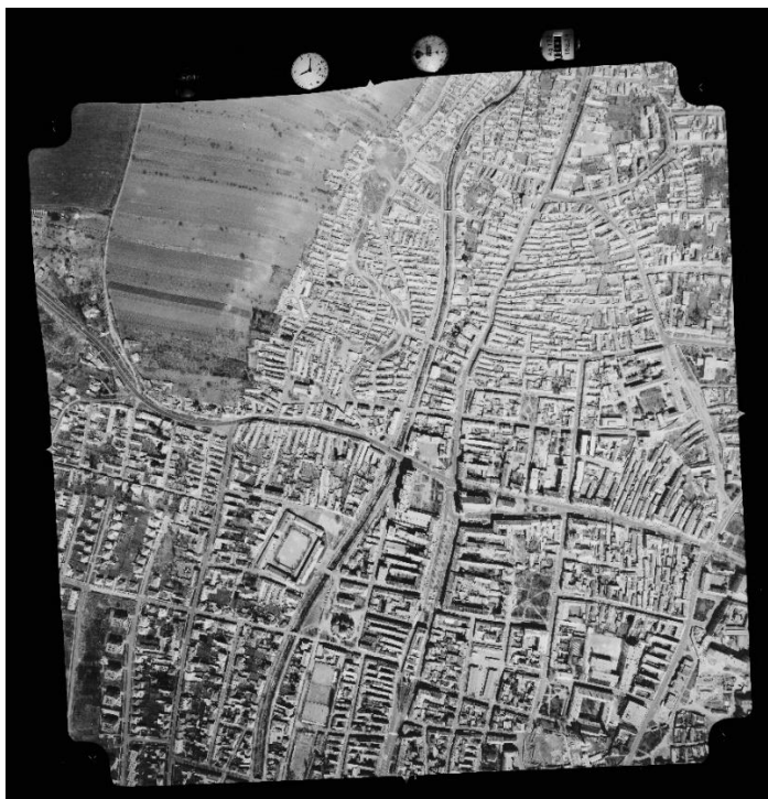
10. ábra: A végeredményként kapott ortofotó. A kép bal felső szélén jól megfigyelhető a domborzat hatása: itt egy domb található, emiatt láthatóan eltorzult a kép – eredetileg egyenes – széle.
