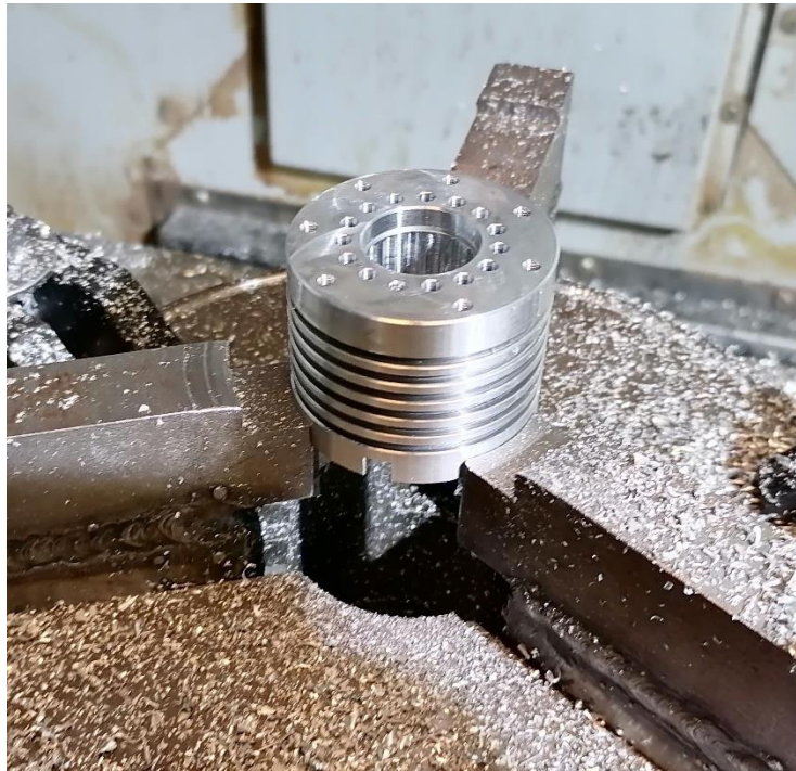
6/3. ábra. Hűtőborda 3. felfogás utáni állapota
