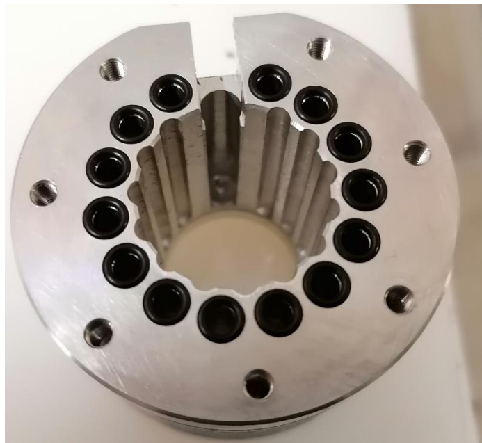
6/4. ábra. Sűrített levegős furatok tömítésének behelyezése
