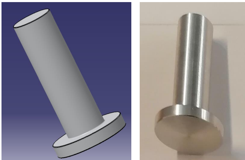
22. ábra. Lézerdiódarögzítését szolgáló szár virtuális és legyártott képe
