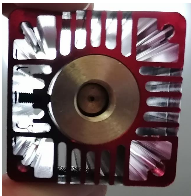
9. ábra. LD4070HF Pro lézergravírozófej hűtőbordájának hibája
