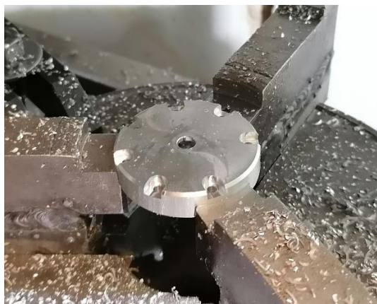
19. ábra. Sűrített levegőt terelő elem virtuális és legyártott képe
