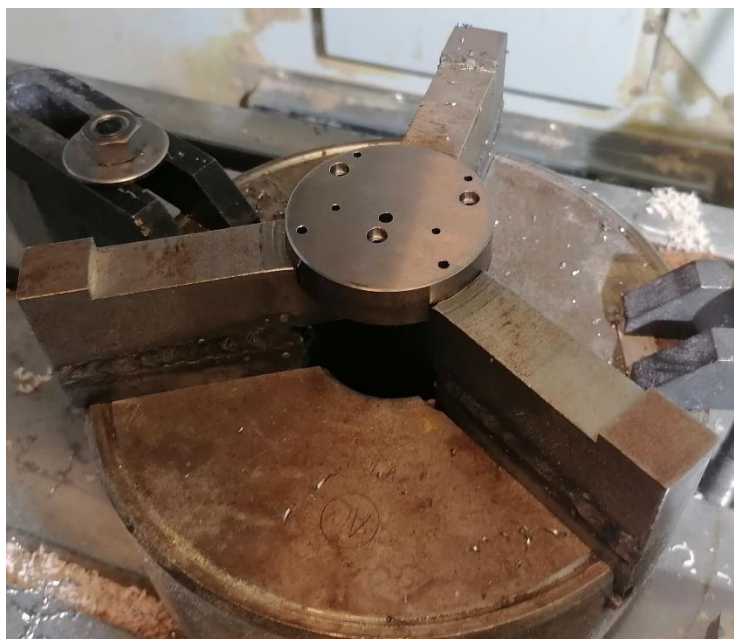
6/1. ábra. Felfogótárcsa furatainak elkészítése
