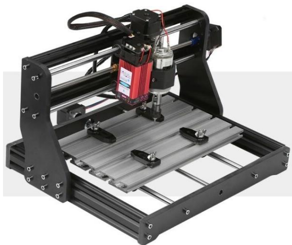
5. ábra. Asztali CNC maróra szerelt lézermódul [11]
