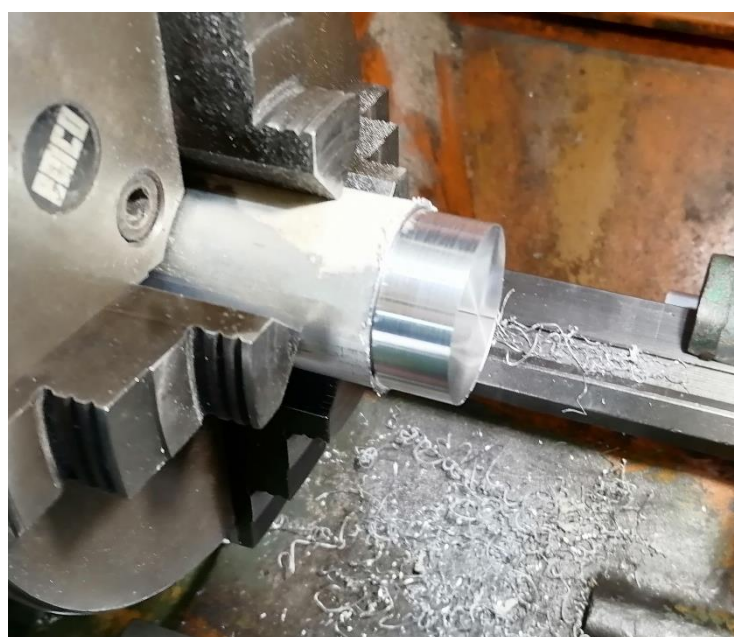
6/2. ábra. Hűtőborda Ø48 mm-es átmérőre esztergálást követően (1. felfogás)
