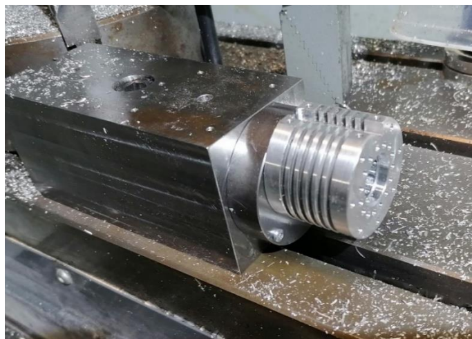
17. ábra. A munkadarab állapota a 4. felfogás után
