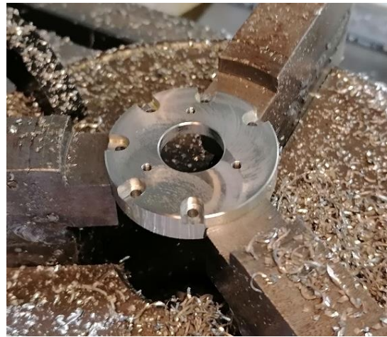
23. ábra. Lézerdiódarögzítését szolgáló szár virtuális és legyártott képe
