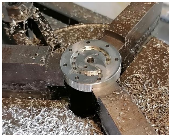
21. ábra. Sűrítettlevegő elosztását megvalósító elem virtuális és legyártott képe
