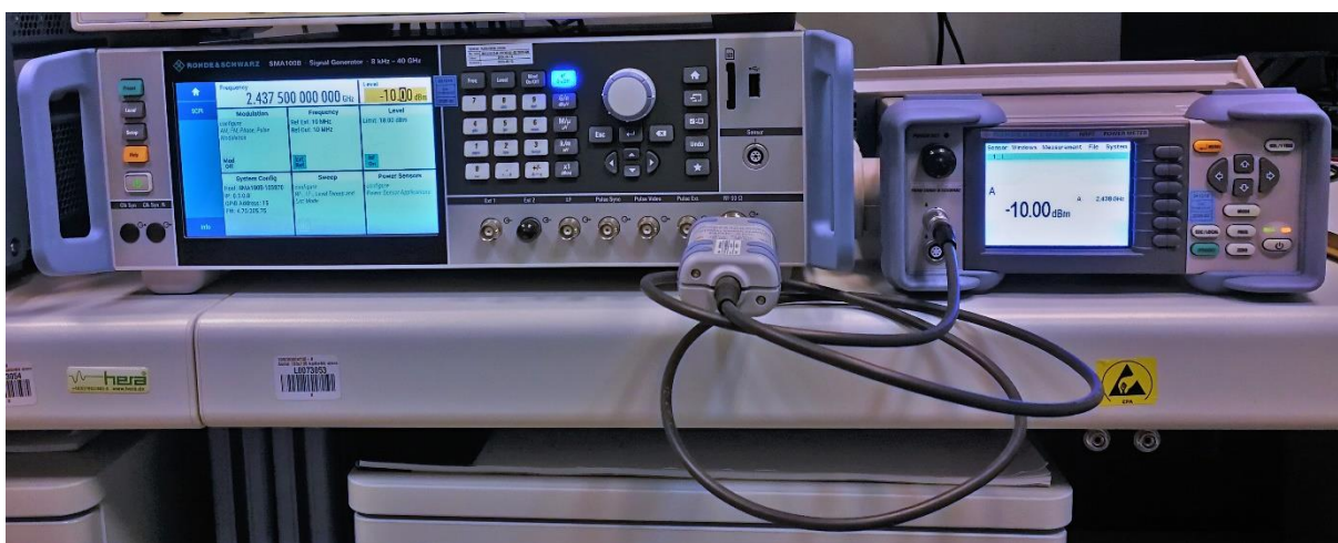
2.1. ábra: Frekvenciafüggés és linearitás ellenőrzés mérési elrendezés. Balra a generátor, NRP-Z55 a generátor RF kimenetéhez csatlakoztatva, jobbra az NRP2
