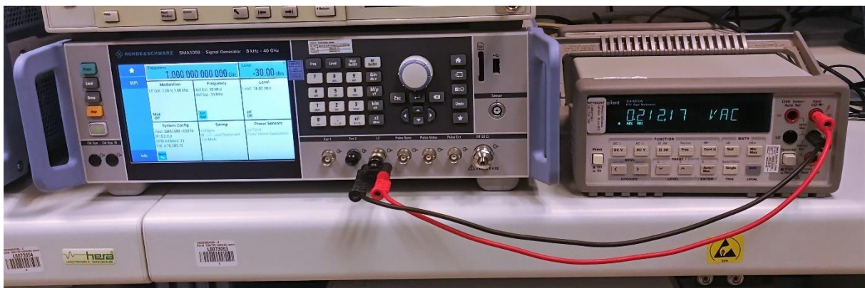
4.1. ábra: Moduláló generátor ellenőrzés mérési elrendezés Forrás: Szerkesztette a szerző
