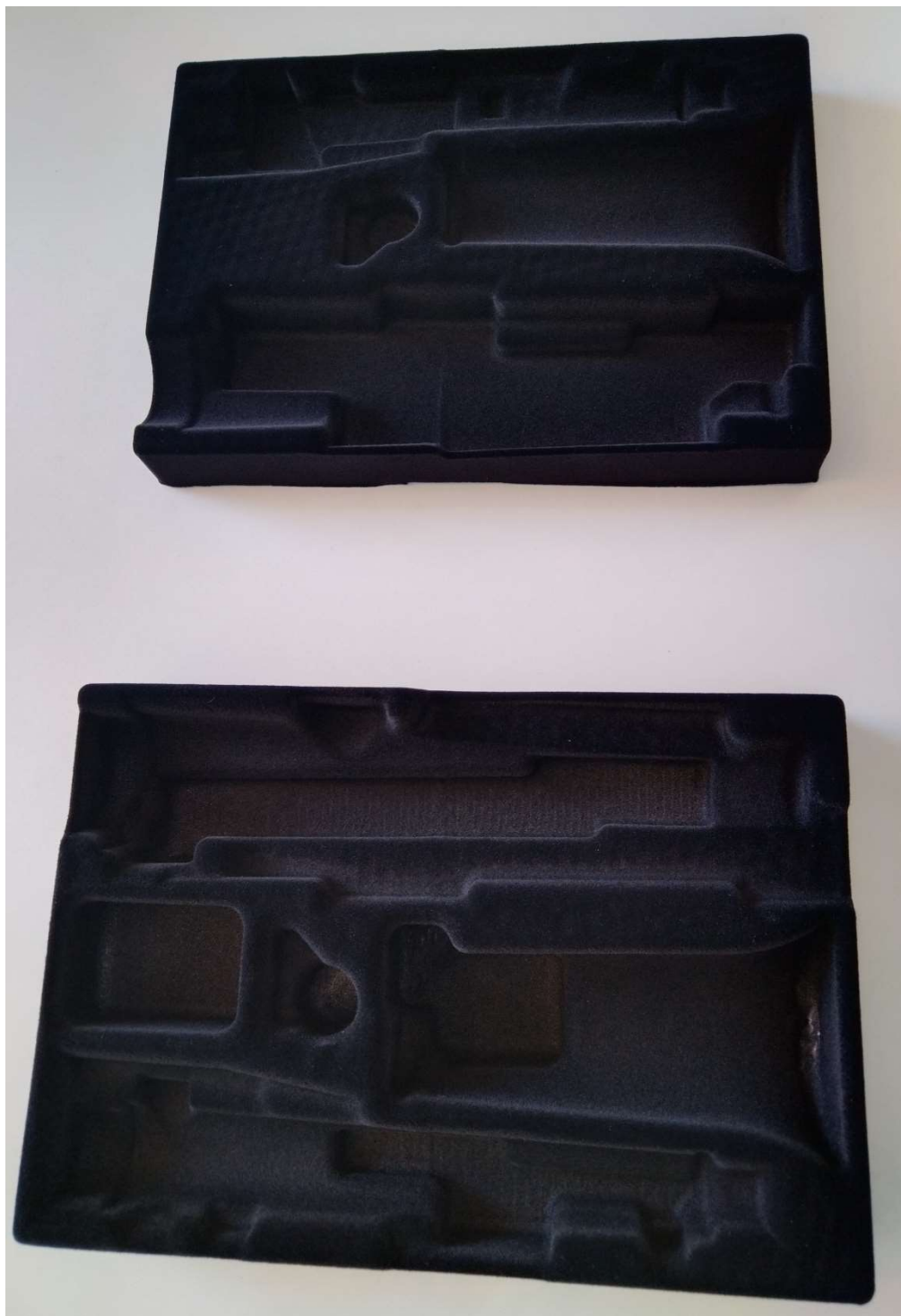
4.11. ábra: Feketére flokkolt munkadarab
