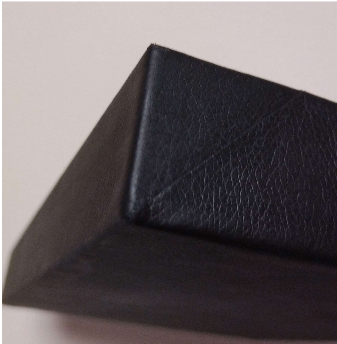
4.15. ábra: Sarok kialakítás illesztett éllel
