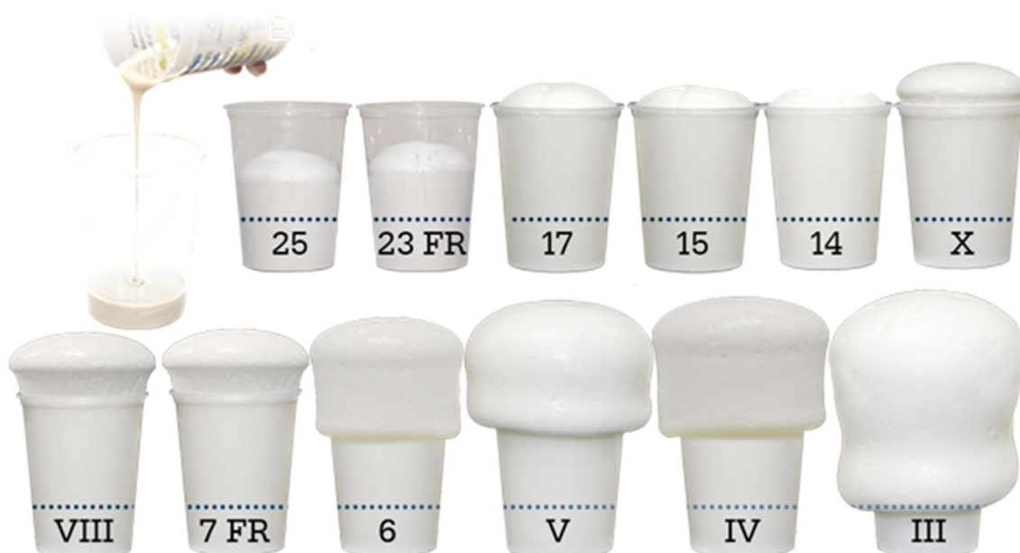
3.20. ábra: Különböző tágulású és merevségű változatok
