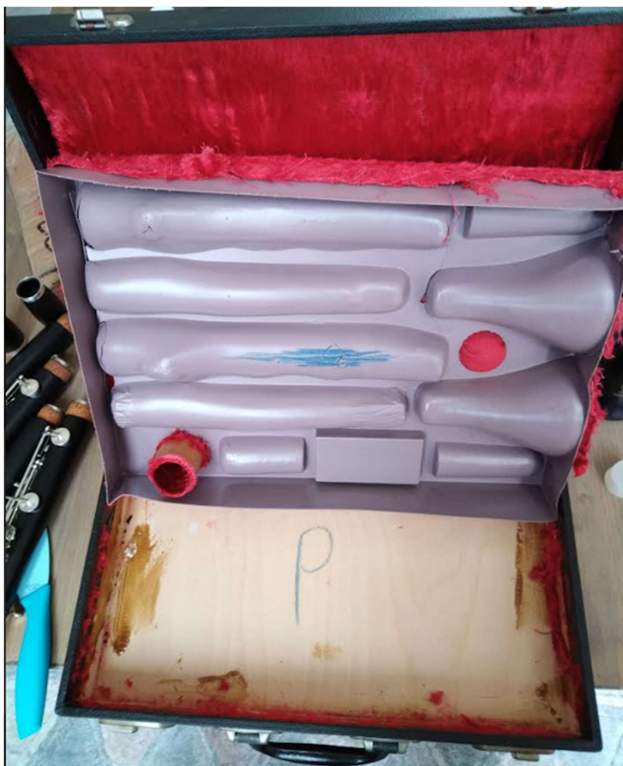
3.22. ábra: Vákuumformázott műanyag lemez
