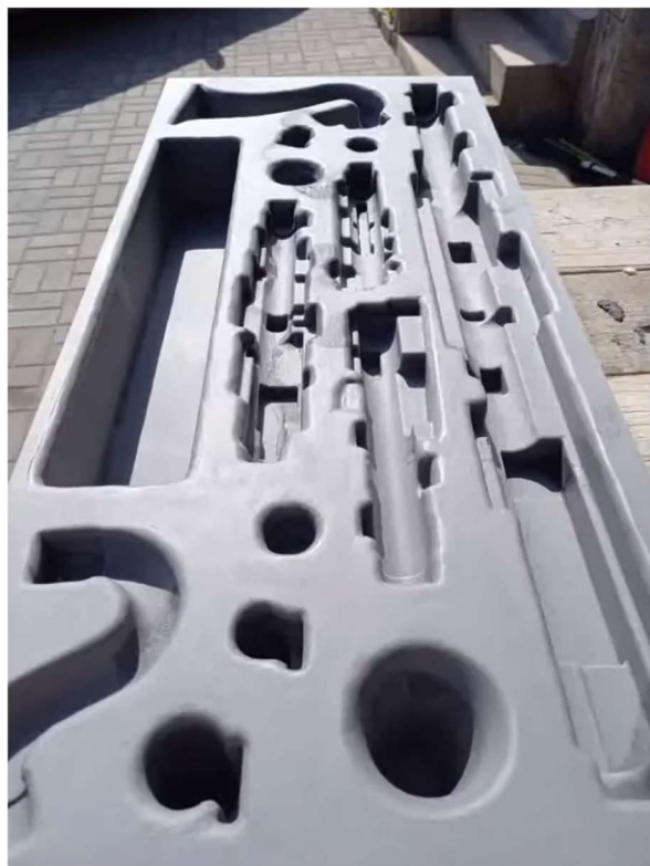
4.3. ábra: Elkészült PU hab forma tripla tokhoz
