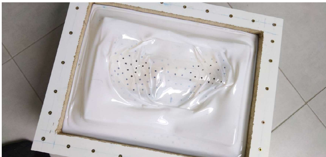
4.6. ábra: A meghűsült vákuumhúzás eredménye
