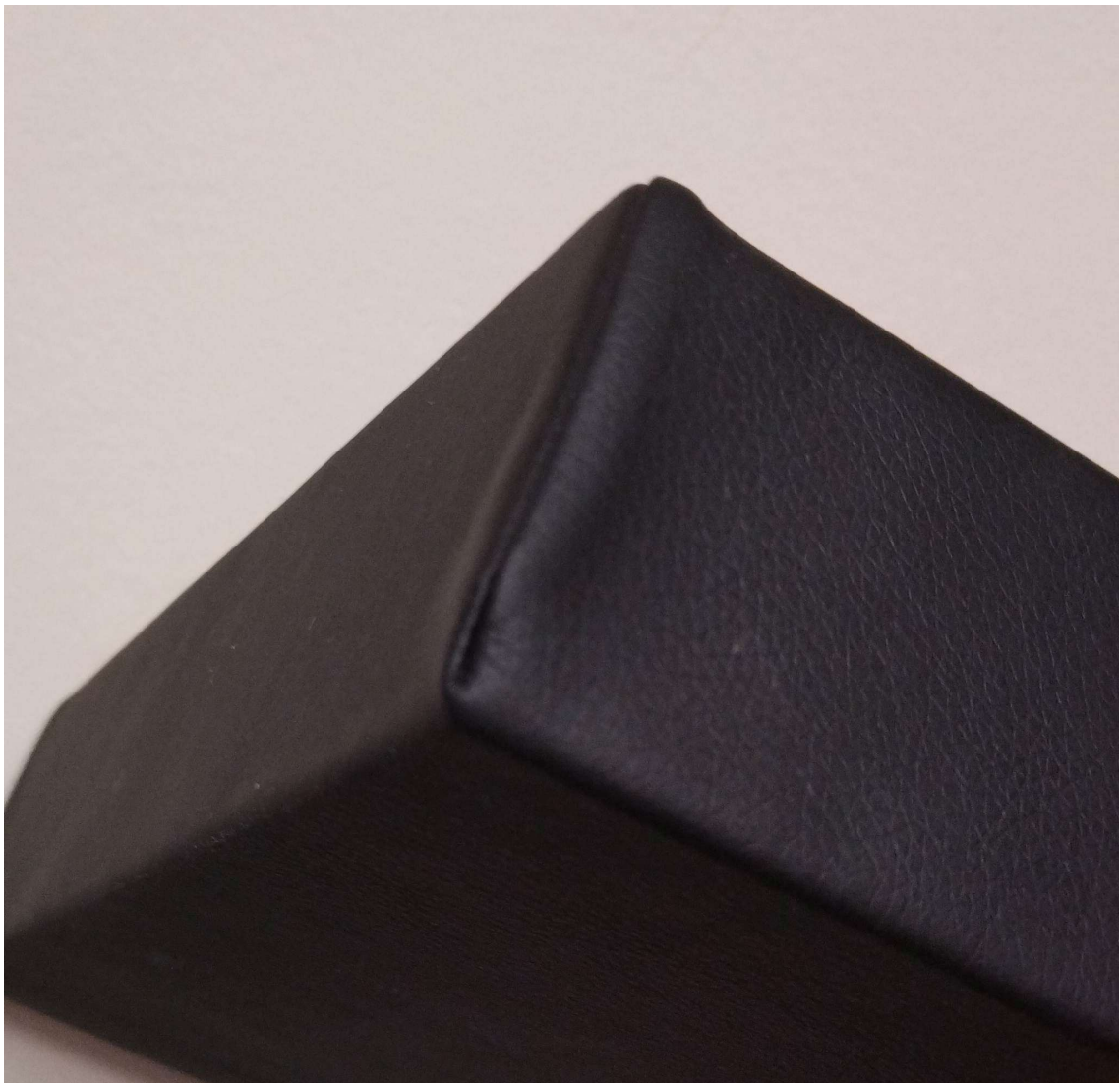
4.14. ábra: Túlzott anyagvastagság a varrott saroknál
