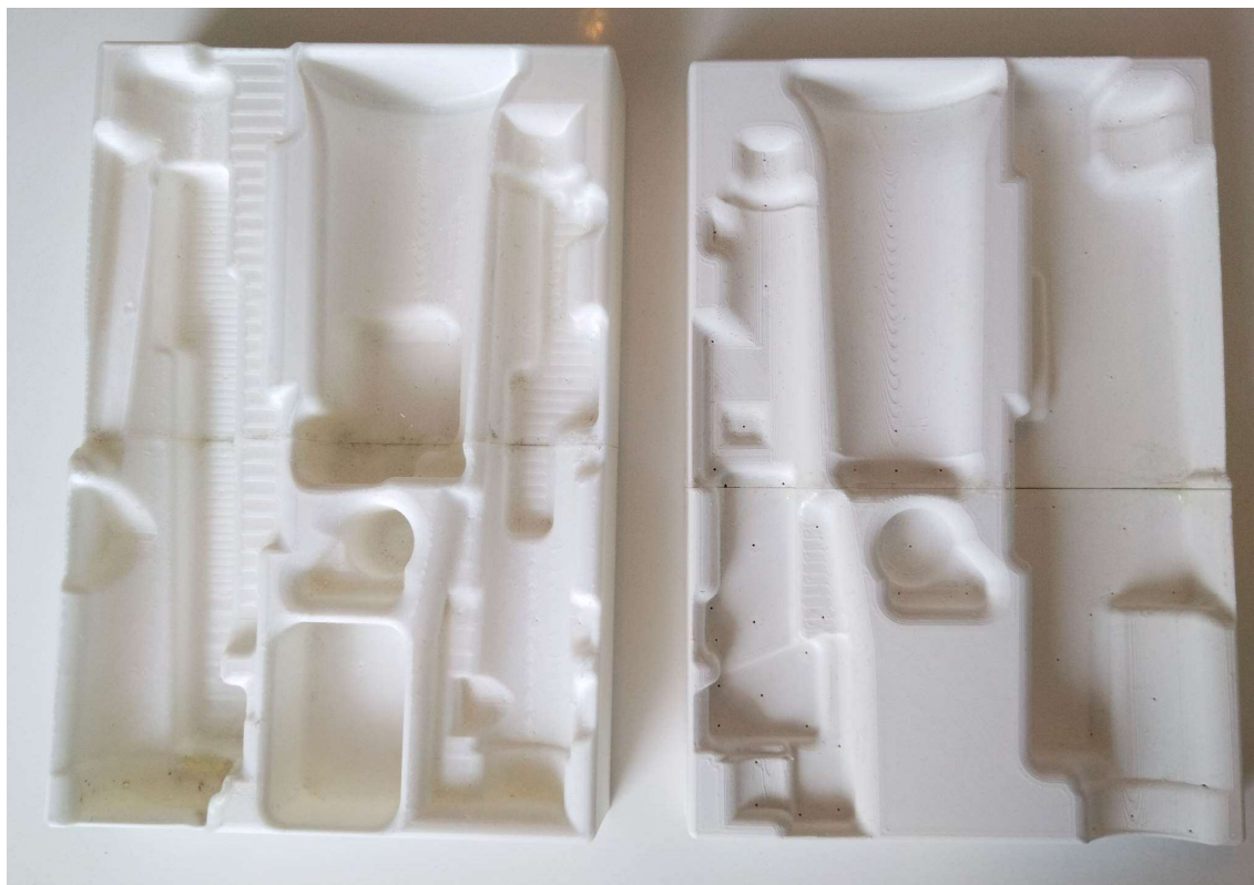
4.5. ábra: Pozitív vákuumformázó szerszám
