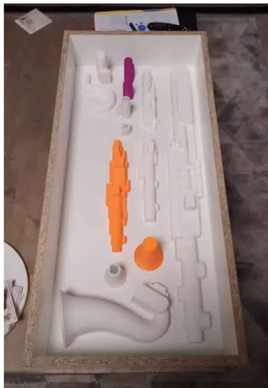
4.2. ábra: Triplatok öntőformája
