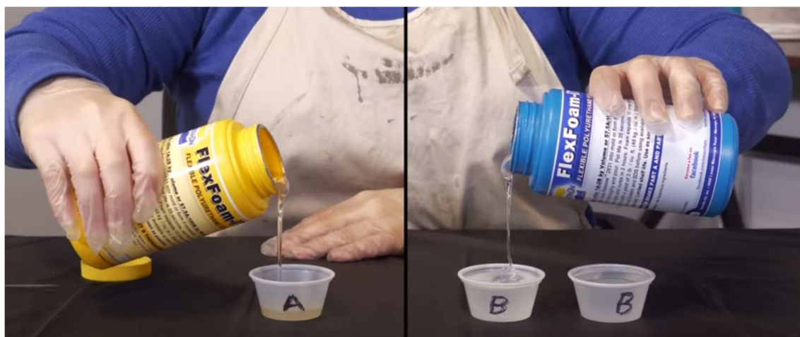
3.19. ábra: FLEX Foam-it! PU hab komponensei
