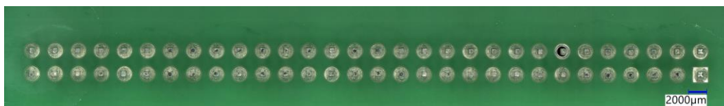
34. ábra: HASL panelbevonat, referenciapanel, J1 csatlakozósor – furatkitöltési probléma [saját kép]
