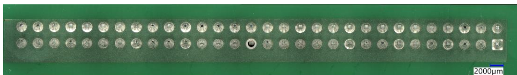
29. ábra: A lézeres felületkezelés hatása ImSn panelbevonaton J1 csatlakozó mentén – elváltozás a forrasztásgátló maszkon
