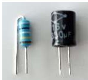
6. ábra: Alkatrészek lábak beállítása: ellenállás (bal) és kondenzátor (jobb)
