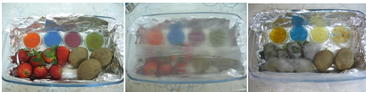
27. ábra. Az agar filmben lévő növényi színanyagok és a bromtimolkék színváltozásának tesztelése az eper romlási folyamata és a burgonya csírázása során
