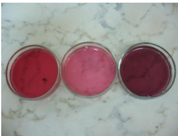
25. ábra. A céklalé színváltozatai agar filmben pH 7; 10,6 és 3 értékeknél
