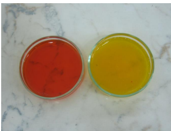
24. ábra. A kurkumin színváltozatai agar filmben pH 12 és pH 4,63 értékeknél
